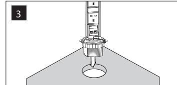
Abra un agujero de diámetro de 90-92mm en el superficie de trabajo. Deje un mínimo de espacio de 25mm alrededor del agujero. Al escoger el lugar, elija una superficie entre 10mm y 50mm de espesor. **ATENCIÓN:** Asegure que haya suficiente espacio debajo del superficie de instalación para la unidad cuando retira a la posición cerrada.
