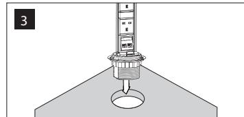
Percez un trou 90-92 mm diamètres au poste de travail. Mettez de coté 25mm minimum autour le trou. En choisir une location, assurez-vous que la surface est au milieu de 10mm et 50mm d'épaisseur. Attention : Assurez-vous qu'il y a espace suffisante au dessous la surface d'installation pour le produit quand en rentrer en position fermé.
