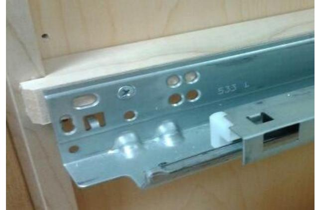
4. Repousser la tablette coulissante (pièce A) sur ses glissières jusqu'à ce que leurs crochets s'insèrent dans les trous percés sous la tablette coulissante. Une fois la tablette coulissante complètement enfoncée, vous entendrez l'emboîtement de la glissière dans le mécanisme de verrouillage préassemblé sur le devant de la tablette coulissante. La tablette coulissante peut être retirée en pressant les taquets de verrouillage et en tirant vers l'avant.
