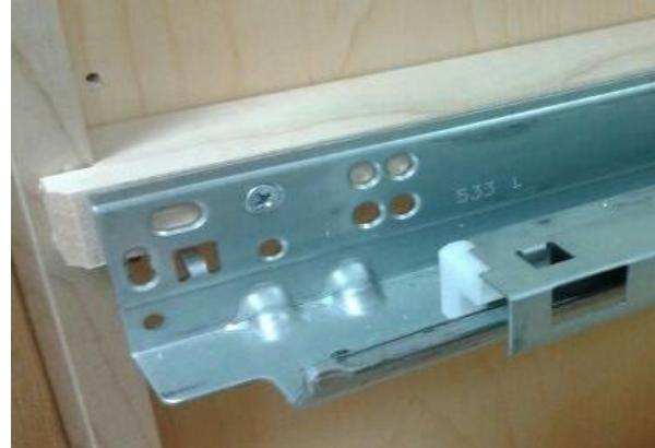
4. Empuje la bandeja corrediza (parte A) de nuevo sobre la ferretería del cajón hasta que los ganchos metálicos se inserten en los orificios taladrados en la parte posterior de la bandeja corrediza. Escuchará que las piezas metálicas se enganchan a los mecanismos de bloqueo de plástico instalados debajo de la parte delantera de la bandeja corrediza, cuando estén en la posición adecuada. La bandeja corrediza puede quitarse oprimiendo los mecanismos de bloqueo de plástico y tirando hacia delante.
